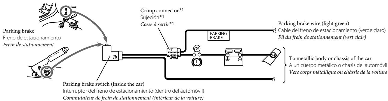
**C Connecting the parking brake wire (When installing the monitor in a location where it **cannot** be seen by the driver) / Conexión del cable del freno de estacionamiento (Al instalar el monitor en un lugar donde **no pueda** ser visto por el conductor) / Connexion du cordon de frein de stationnement (Lorsqu'on installe le moniteur à un emplacement où il **ne peut** pas être vu du conducteur)**
